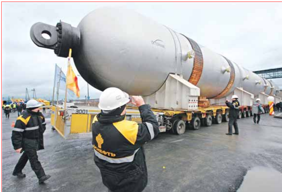
Un empleado toma fotos de un reactor de hidrocrackeo de mil 450 toneladas, que arriba a la refinería Achinsk, de la petrolera Rosneft. El traslado duró unos dos meses y se realizó en una gigantesca plataforma con neumáticos de caucho, que se mueve a una velocidad media de 2 kilómetros por hora ■ Foto Reuters
