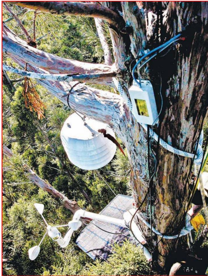
Diversos sensores —para medir viento, temperatura y savia— instalados en un bosque de Australia ■ Imagen tomada de [www.ictinternational.com.au](http://www.ictinternational.com.au)
