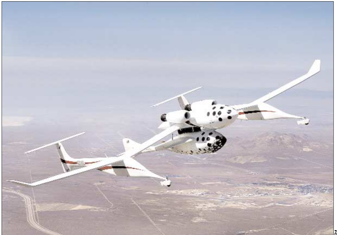
La nave espacial SpaceShipOne fue transportada por el avión White Knight a 16 mil metros de altura de donde, ya con sus potentes motores en operación, partió hacia su incursión suborbital
